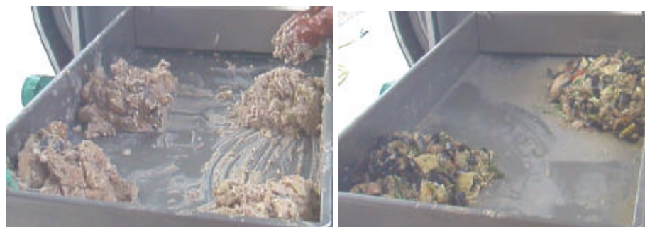
Phases des opérations de tri et de quartage des déchets, effectuées afin de caractériser les entrants en terme de composants alimentaires et de constituer des échantillons représentatifs pour les analyses de laboratoire
